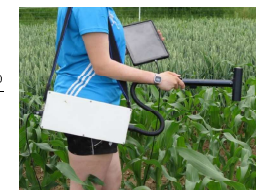
Abb. 4: Formel des REIP Vegetationsindex und handgetragener Sensor
