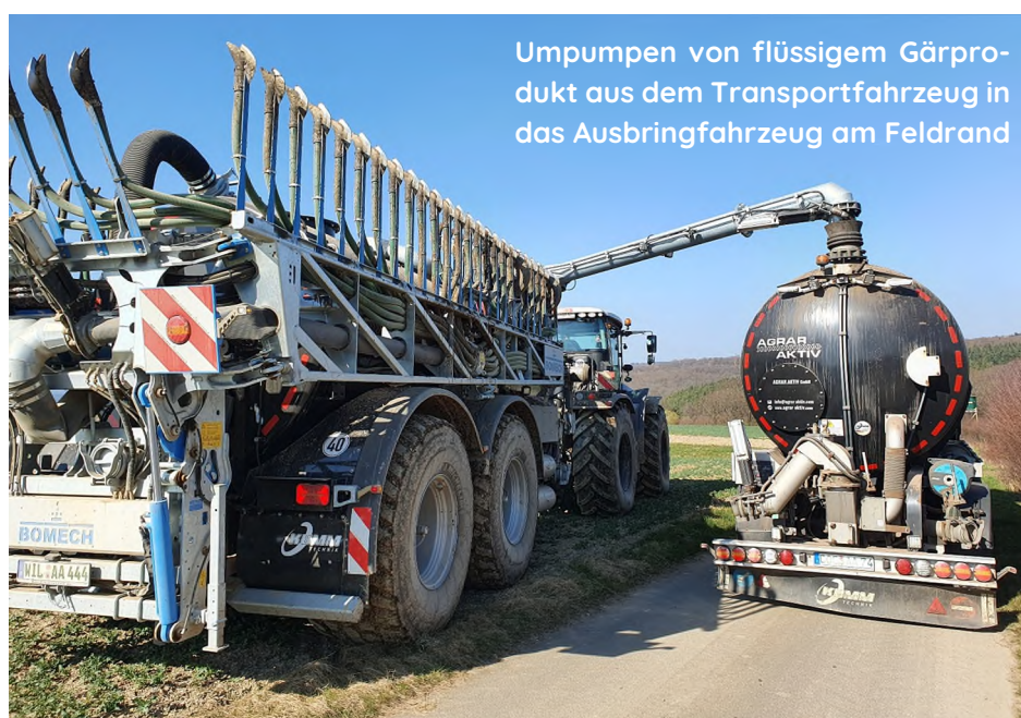
Befüllung von Tanktransportern mit flüssigem Gärprodukt einer Biogutvergärungsanlage
