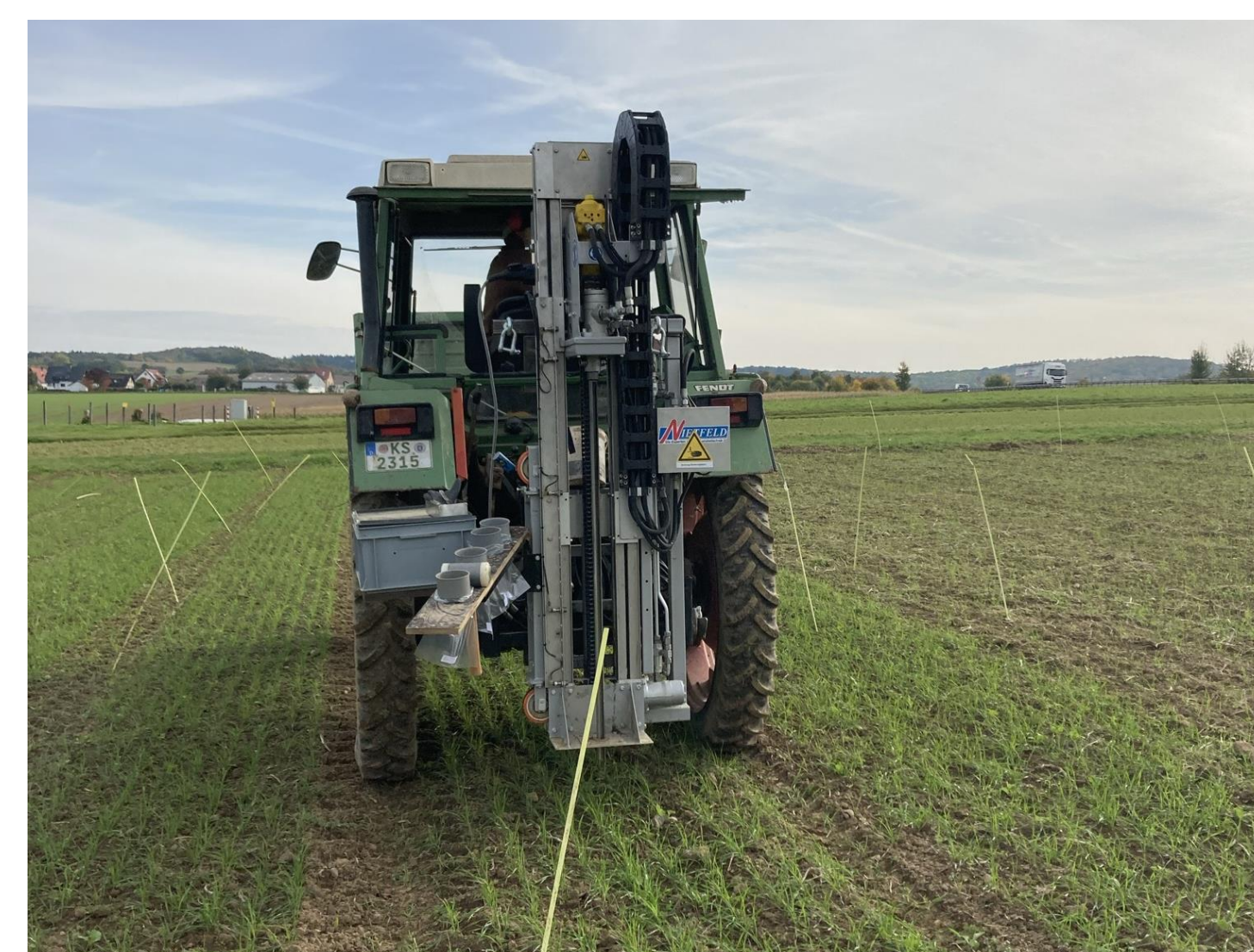
Bodenprobennahme und Gasmessungen auf der Versuchsfläche in Selters (Taunus)
