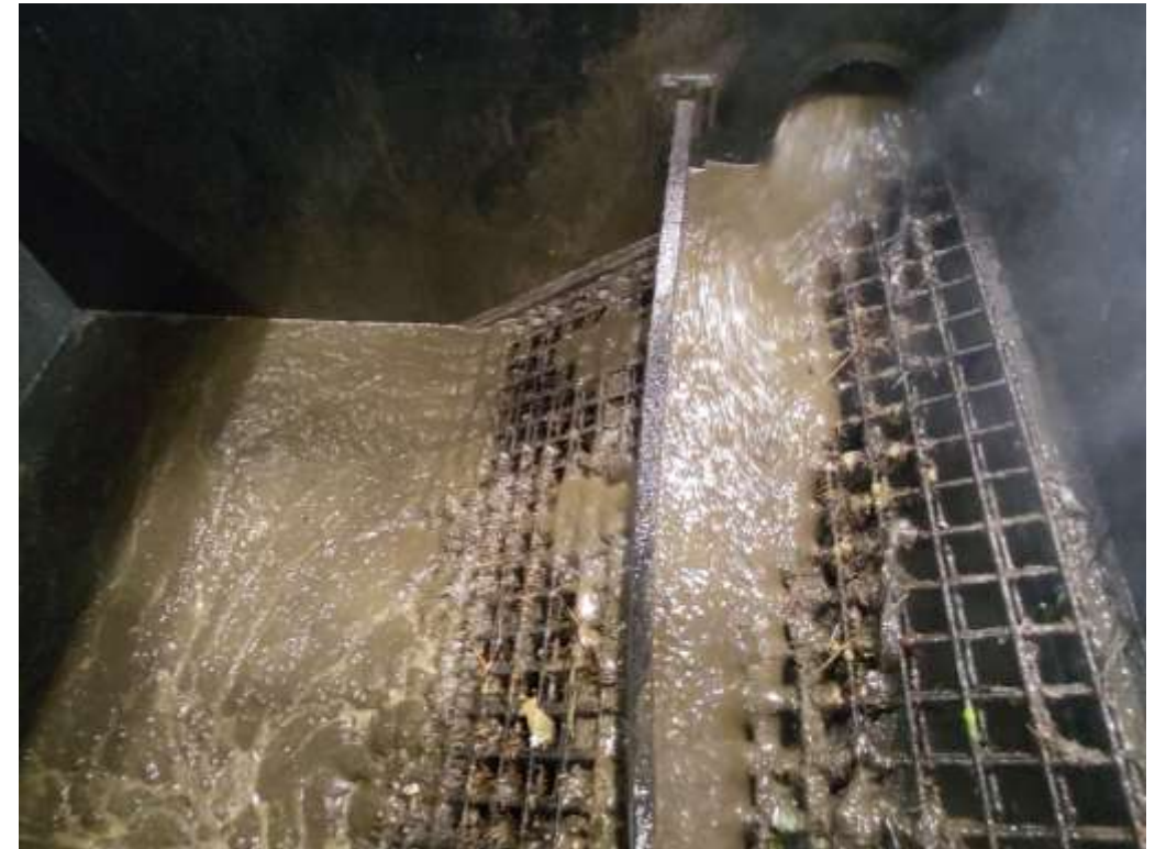
Flüssigphase Gärproduktes (RETERRA Hegau Bodensee)
